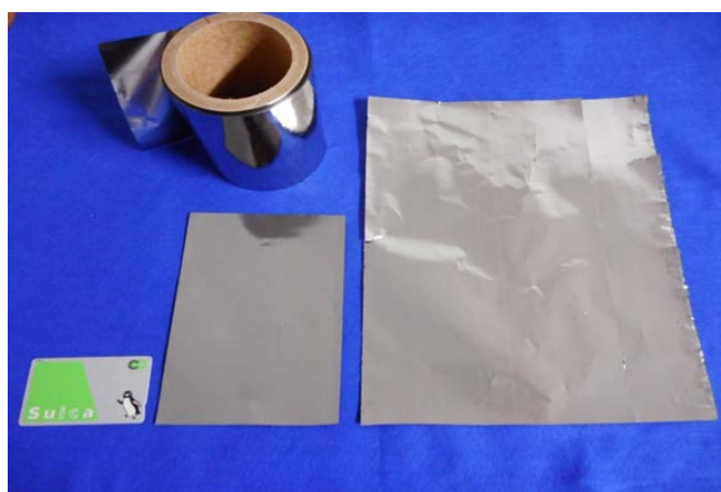
図2 ナノ結晶薄帯（幅127mmと245mm）
